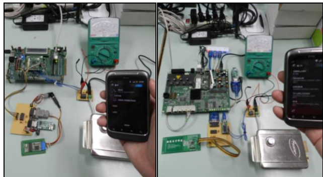
(a) 低階門禁控制器使用 Bluetooth 識別 (b) 高階門禁控制器使用 Wi-Fi 識別
