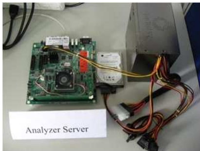
圖 9 Analyzer Server 子系統平台
